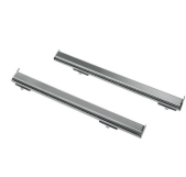
GT1P-2 מסילות טלסקופיות ניתנות להוצאה חלקית (רמה 1) לתנורים עם מסגרות מתכת. אורך: 355.5 מ"מ, הוצאה: 285 מ"מ. מצוחצת AISI 430 מ"מ. חומר: נירוסטה
