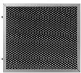
Longlife-Aktivkohlefilter, rechteckige Bauform, für Serie KBT\*, KBCT\*, spülmaschinengeeignet, bis zu 12x regenerierbar, Trocknung im Backofen bei max. 90°C für 60 min., Abm. LxBxH: 237,5x245x10 mm
