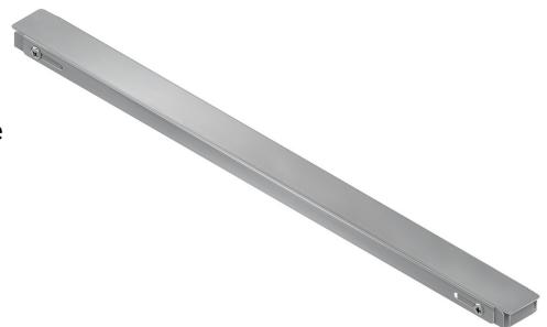
Teleskop-Verbindungsleiste aus Edelstahl, Auszugstiefe 475-495 mm, für die Montage von zwei Kochfeldern parallel in einem Arbeitsplattenausschnitt
