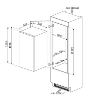
Высота изделия 1218 мм Высота ниши для 1225 мм встраивания Ширина с дверцей, 548 мм открытой на 90° (мм)
