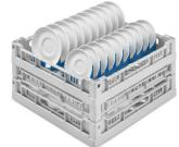
Cesto doppio in polipropilene universale fondo piano, 20 piattini cesto superiore, altezza interna cesto inferiore 120 mm, dim.(LxPxH) 400x400x227 mm
