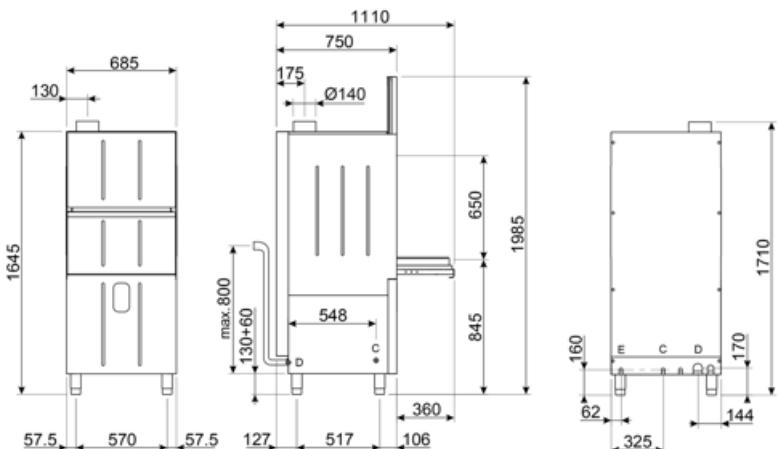
D = SCARICO 15°, VIDANGE 15°, DRAIN 15°, ABFLUSS 15°, DESAGÜE 15°, СИД 15°
