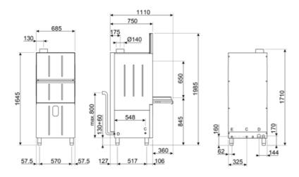
D – SCARICO 191°, VIDANGE 191°, DRAIN 191°, ABFLUSS 191°, DESAGÜE 191°, CHBB 191°
