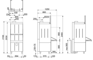
D – SCARCO 197, VEDANGE 197, DRAN 197, ARTUSS 197, DEMOČE 197, CHBI 197 C – CARCAMENTO ACQUA 1º GAS, CHARGEMENT EAU 1º GAZ, WATER INLET 1º GAS, ZUFLUSS 1º GAS, CARGA AGUA 1º GAS, HAROP BOXIM 1º GAS E – ALLACCIAMENTO ELETTRICO, BRANCHEMENT LLECTRICO, ELECTRIC CONNECTION, ELECTRICO, RUBANGUE SONEXION ELECTRICA, SHEKTPHUCKOR DOJICHOPEDRE
